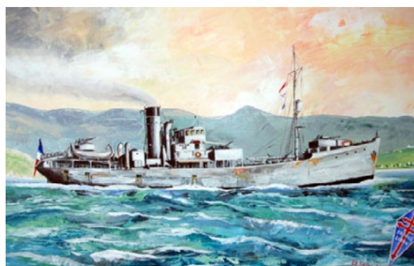
La Reine des Flots , 607 t, 52 m de long sur 8,2 m de large, tirant d'eau de 4,8 m, 11 nœuds (© R. Lunardo).
