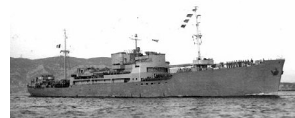
Le Cap des Palmes , déplacement 4 150 t, 108 m de long, 13,4 m de large, 5,5 m tirant d'eau, 15 nœuds (coll. FFL).
