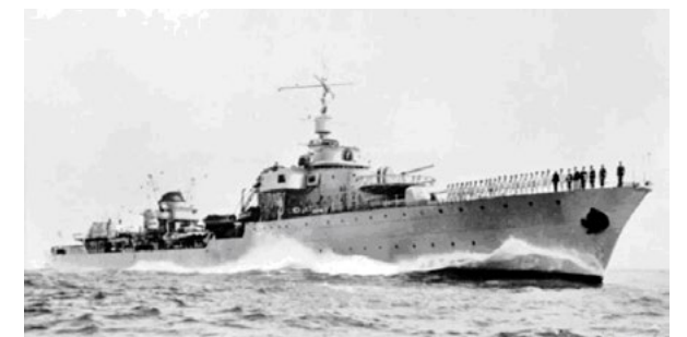
Le Triomphant (3 200 t, 132,4 m de long par 12,3 m de large, 5 m de tirant d'eau, vitesse 43 nœuds) dispose d'un équipage de 13 officiers et 197 hommes (coll. FFL).
