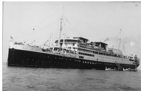
Le Félix Roussel , 17 000 tx, 182 m de long par 20,8 m de large, 8,3 m de tirant d'eau, vitesse de 18 nœuds, 258 membres d'équipage, 1 900 passagers (coll. FFL).
