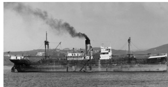
Le Capo Olmo : 4 712 tonnes, 110 m de long par 16 m de large, tirant d'eau de 7,8 m, vitesse de 11 nœuds (coll. FFL).
