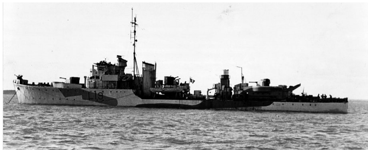
La Combattante (1 300 t, 85 m de long x 10 m de large, 3,6 m de tirant d'eau, 28 nœuds) est armée de 4 canons de 102 mm, 4 de 40 mm, 6 de 20 mm, 2 grenadeurs et 4 mortiers. Elle est dotée de trois radars et d'un ASDIC (coll. FFL).
