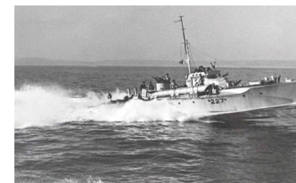
La vedette lance-torpilles MTB 227 : 60 t, 21,30 m de long sur 5,5 m, 1,85 m de tirant d'eau, 42 nœuds (coll. FFL).
