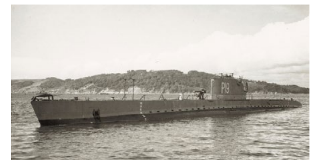
La Junon (68 m de long x 5,6 m de large, 660 t, 14,5 nœuds) plonge à 80 m maximum (coll. FFL).
