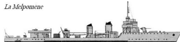
La Melpomène (900 t, 80,7 m de long x 8 m, 3 m de tirant d'eau, 34 nœuds), 2 canons de 100 mm, 4 tubes lance-torpilles de 550, 4 mitrailleuses de 13,2, un grenadeur (FFL).
