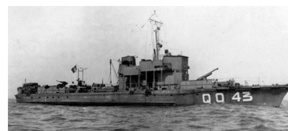
Chasseur 43 Lavandou : 160 t, 37 m de long sur 5,5 m, 2 m de tirant d'eau, 16 nœuds, équipage 29 marins (coll. FFL).
