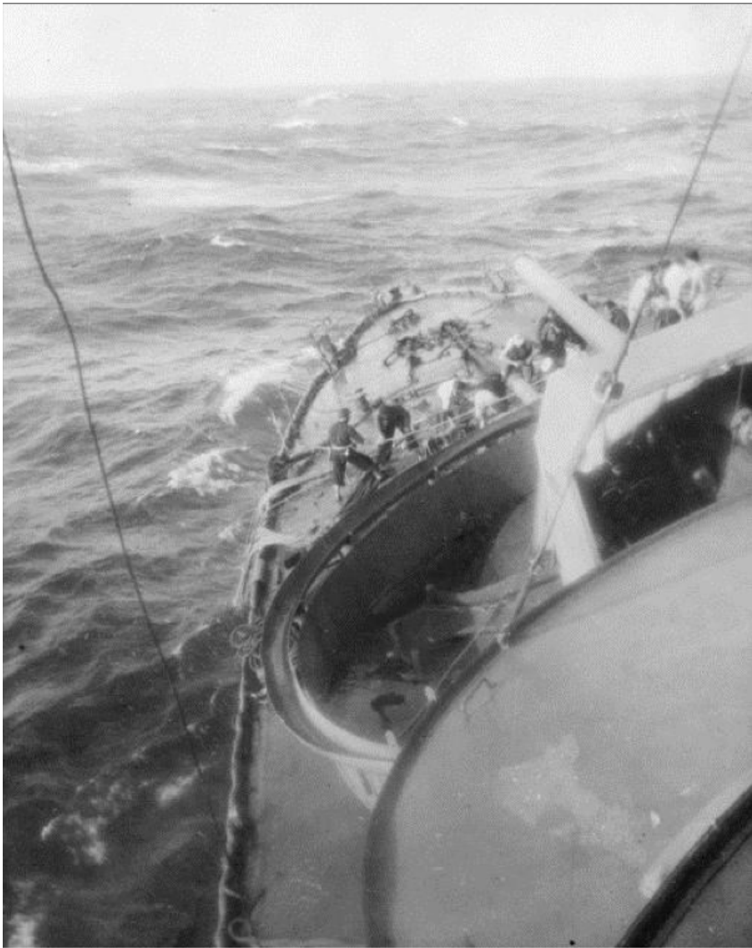
Document 4 - LE TRIOMPHANT, photographie datée du 2 décembre 1943 après les avaries liées au cyclone, l'équipage met en place, par l'extérieur, une tape pour obturer une brèche (Australian War Museum, référence P05103.005, document dans le domaine public)
